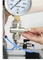
→ En ocasiones la presión puede ser tan pequeña que no se pueda leer con el manómetro, en esos casos abrir la válvula de la imagen y tomar la lectura del tubo piezométrico situado en la parte trasera.¶
