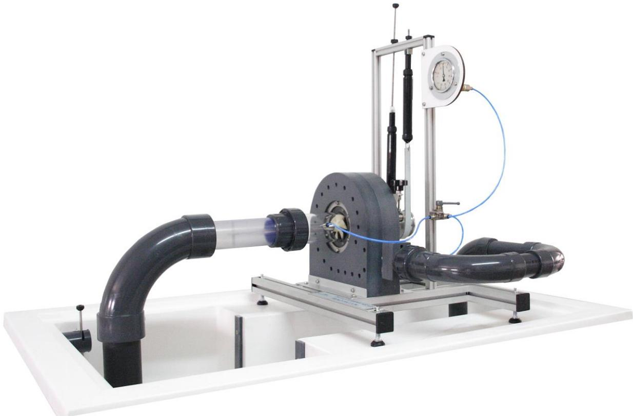
El equipo TH 01.4 simula una instalación a pequeña escala con una turbina Kaplan/Hélice, y está diseñado para el estudio y visualización tanto del comportamiento como de sus características.
