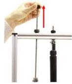
Para aflojar la cinta, debemos volver a tirar de la tuerca moleteada hacia arriba y girar la tuerca de bloqueo para que suelte la varilla.¶
